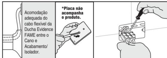
Passo o conjunto (Acabamento/Isolador + cabos + aterramento) da Ducha Evidence FAME pela Placa (não acompanha o produto). Ligue os cabos, utilizando o Conector (não acompanha o produto) que deve ser bem apertado e colocado dentro da caixa de derivação. Tampe a caixa com a Placa e parafuse-a.
