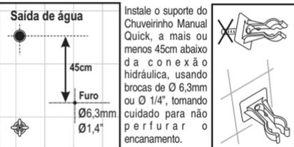
Instale o suporte do Chuveirinho Manual Quick, a mais ou menos 45cm abaixo da conexão hidráulica, usando brocas de Ø 6,3mm ou Ø 1/4", tomando cuidado para não perfurar o encanamento.
