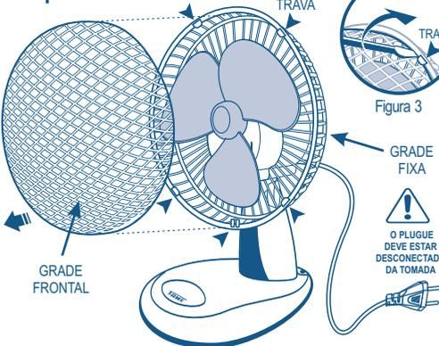
Antes de iniciar o processo de limpeza certifique-se de que o Plugue do Ventilador Personal Fan não está conectado à tomada.
