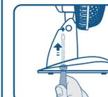
1 - Introduza uma chave de fenda por dentro da Base do Ventilador.
