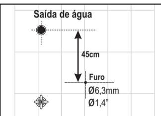
Instale o suporte do Chuveirinho Manual Quick, a mais ou menos 45cm abaixo da conexão hidráulica, usando brocas de Ø6,3mm ou Ø 1/4", tomando cuidado para não perfurar o encanamento.
