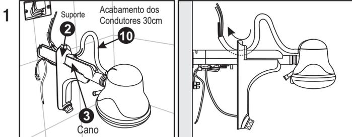
introduza o conjunto Acabamento dos condutores (10) e Condutores no sulco do Cano (3), passando pela abertura superior do Suporte (2).
