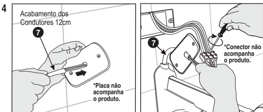
Ligue os cabos, utilizando o \*conector que deve ser bem apertado e colocado dentro da caixa de derivação. Tampe a caixa com a placa (se houver) e parafuse-a.
