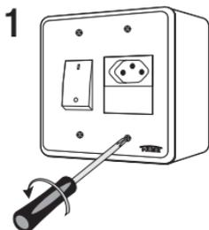
1 Primeiro solte os quatro parafusos com o auxílio de uma chave philips e retire a tampa da Caixa Versátil 1 FAME.
