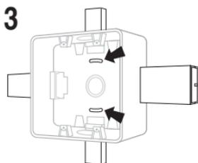
3 Fixe a Caixa Versátil 1 FAME na parede utilizando os furos indicados na ilustração acima.
