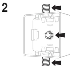
2 De acordo com sua instalação, destaque o(s) encaixe(s) para o condute.
