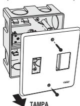
Solte os dois parafusos com o auxílio de uma chave phillips e retire a tampa da Caixa Versátil FAME.
