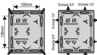
De acordo com sua instalação, destaque o(s) encaixe(s) para condute. Caso o condute seja externo, encaixe-o no respectivo orifício.
