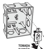
Solte os dois parafusos com o auxílio de uma chave de fenda e retire a Tomada Padrão da Caixa Versátil FAME.
