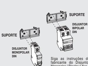
Siga as instruções do fabricante do Disjuntor Monopolar / Bipolar e fixe o mesmo no Suporte.
