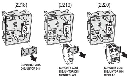
Conforme o modelo de produto, Retire o Suporte para Disjuntor DIN ou retire o Suporte com Disjuntor DIN da Caixa Versátil FAME.
