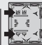
Siga as instruções do fabricante do Disjuntor Monopolar NEMA e fixe o mesmo nas duas garras da Caixa Versátil FAME.
