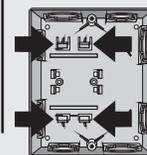
Siga as instruções do fabricante do Disjuntor Bipolar NEMA e fixe o mesmo nas quatro garras da Caixa Versátil FAME.
