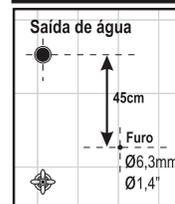
Instale o suporte do Chuveirinho Manual Quick, a mais ou menos 45cm abaixo da conexão hidráulica, usando brocas de Ø 6,3mm ou Ø 1/4", tomando cuidado para não perfurar o encanamento.
