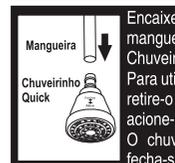
Encaixe uma das extremidades da mangueira no pino de entrada do Chuveirinho. Para utilizar Chuveirinho Manual Quick, retire-o do Suporte, abra o Registro e acione-o. O chuveirinho abre-se, puxando-o e fecha-se empurrando-o.
