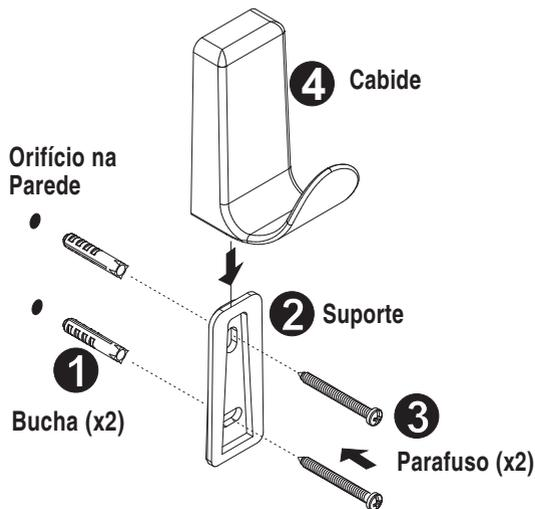
1 - Utilize o Suporte (2) como gabarito, faça a marcação para os dois furos na parede e com o auxílio de uma furadeira faça dois furos usando brocas de Ø 5mm, tomando cuidado para não perfurar encanamentos.
