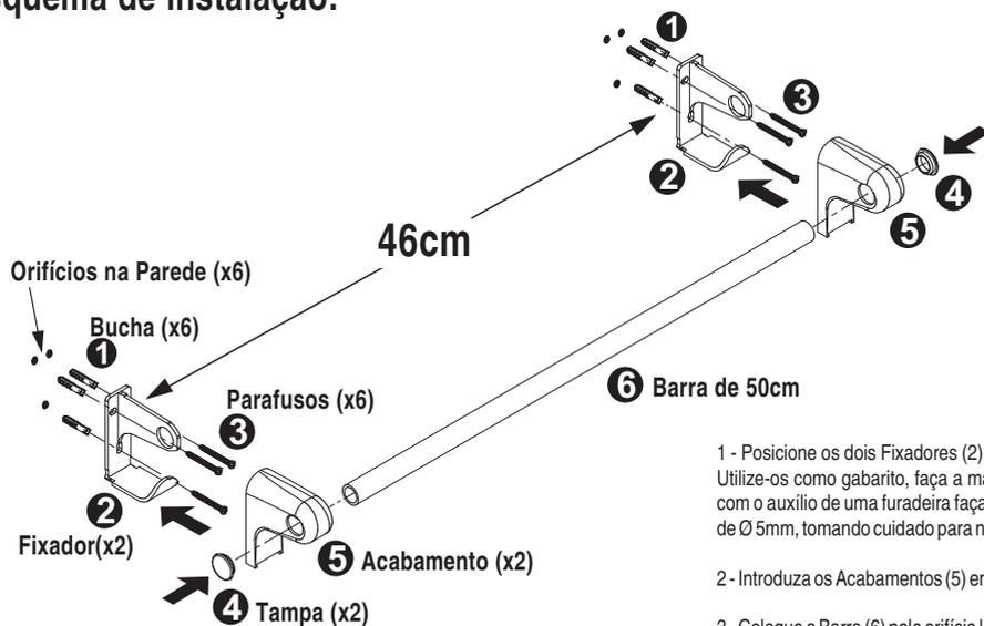
1 - Posicione os dois Fixadores (2) com distância de 46cm entre eles. Utilize-os como gabarito, faça a marcação para os furos na parede e com o auxílio de uma furadeira faça os furos na parede usando brocas de Ø 5mm, tomando cuidado para não perfurar encanamentos.
