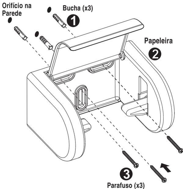
1 - Utilize a Papeleira FAME (2) como gabarito, faça a marcação para os três furos na parede e com o auxílio de uma furadeira faça três furos usando brocas de Ø 5mm, tomando cuidado para não perfurar encanamentos.
