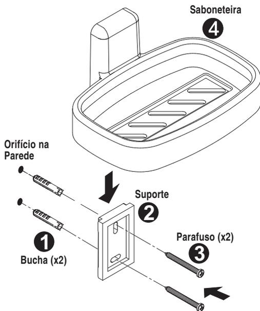
1 - Utilize o Suporte (2) como gabarito, faça a marcação para os dois furos na parede e com o auxílio de uma furadeira faça dois furos usando brocas de Ø 5mm, tomando cuidado para não perfurar encanamentos.
