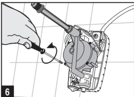
Com o auxílio de uma chave phillips, solte os quatro parafusos que fixam a tampa do Bojo e retire-a.
