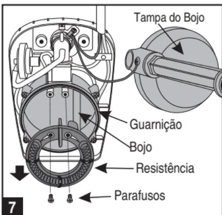
Solte com uma chave de fenda/phillips os dois Parafusos que fixam a Resistência montada avariada, retirando-a. Enxugue e limpe as áreas de contato elétrico, encaixe a nova Resistência e reaperte os dois Parafusos.
