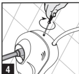
Com o auxílio de uma chave fenda/phillips, solte o parafuso que fixa o Painel no Chassi.
