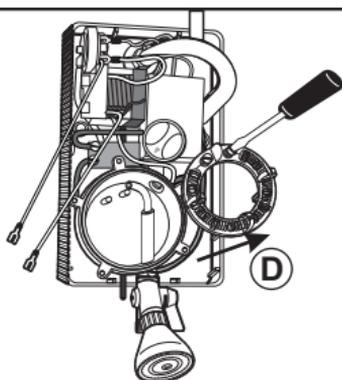
Solte com a chave de fenda os dois parafusos que fixam a Resistência montada avariada, retirando-a "D". Enxugue e limpe as áreas de contato elétrico, encaixe a nova Resistência e reaperte os dois parafusos.
